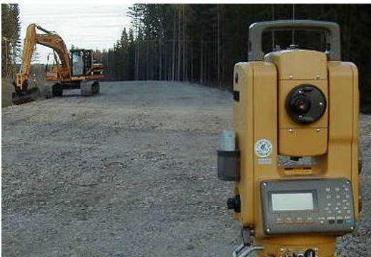
Vanlig fjärrstyrd totalstation
