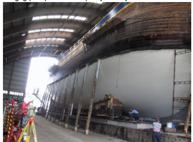
Mätning av Göteborg strax före sjösättning. Lägga märke till att Hans fortfarande mäter med sin DI3000 på en Leica TC1000. I Stockholm använder man fjärrstyrda instrument med centraloptik, vilket ger ännu större möjligheter till rationell fartygs-mätning
