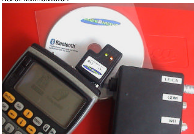
Bluetooth/RS232-Kit för fjärrstyrning av totalstationer.
