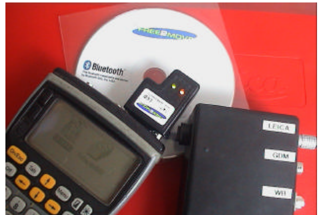
Bluetooth/RS232-Kit för fjärrstyrning av totalstationer.
