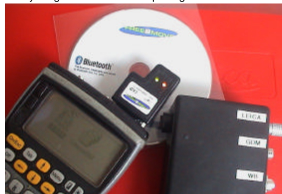
Bluetooth/RS232-Kit för bl.a. fjärrstyrning av totalstationer.
