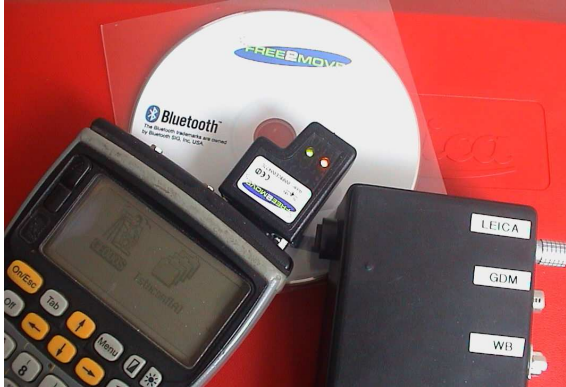
Bluetooth/RS232-Kit för bl.a. fjärrstyrning av totalstationer.
